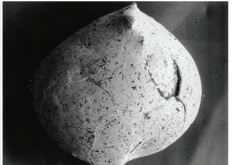
C-4-2 熔滴の表面 (電子顕微鏡観察)
