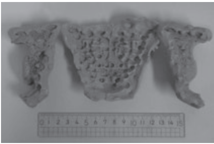
図4 型取りしたシリコン范 图4 翻模后的硅胶范 丹羽撮影／丹羽拍摄
