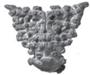
図9 実験製作試料(蠟原型・範3) 图9 实验铸造样品(蜡模・範3) 奈文研写真室撮影／ 奈文研撮影技術室拍摄
