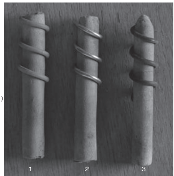
图5 第1回実験 らせんテストピース(原型) 1. 蜜蠟原型(非分割範) 2. 錫原型(非分割範)、 3. マイクロワックス原型(非分割範)
