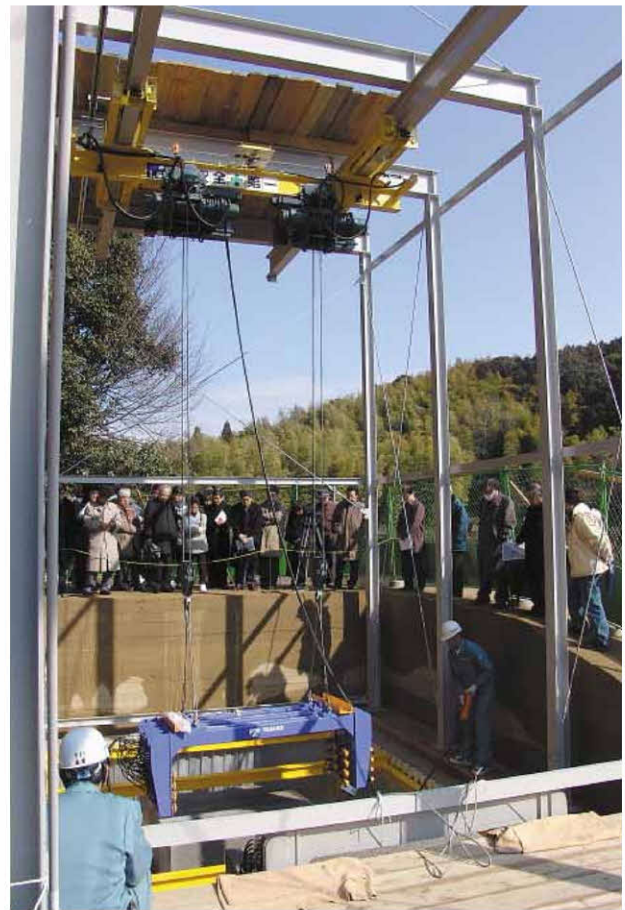
実験場における天井石の吊り上げ実験
