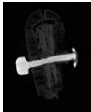
図44 目釘部分のX線CT画像
