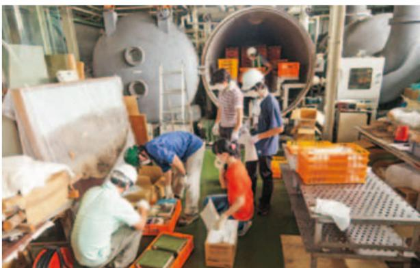
大型真空凍結乾燥機による水損紙資料の乾燥
