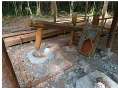
強化土壌に混ぜるためのラテライト粉末を作るための臼と杵 Mortar and pestle to make laterite powder for the consolidated soil
