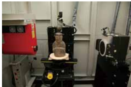
マイクロフォーカス X 線 CT 装置を用いて男神像の断層撮像をしているところ
