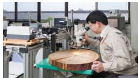
年輪読取器を使ってヒノキ円盤の年輪を計測しているところ
