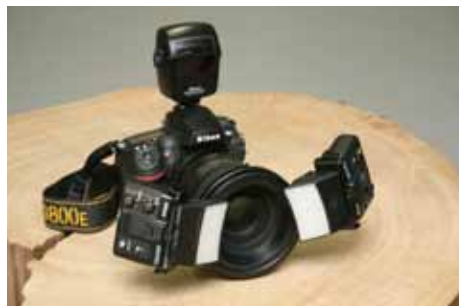
接写用ストロボとマクロレンズを装置した高画素数（3630万画素）のデジタル一眼レフカメラ
