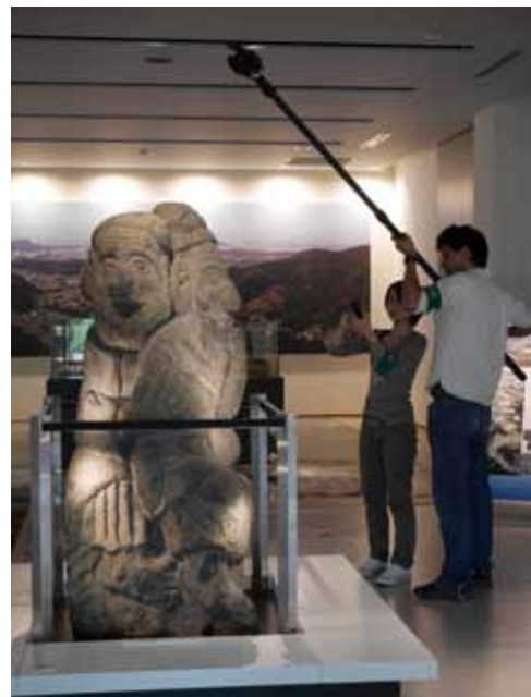
SfM による石造物の計測
