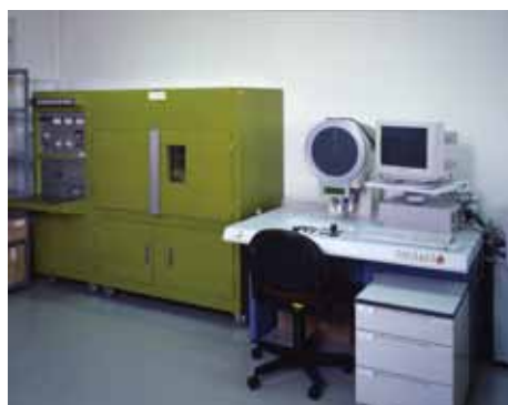
左側はX線露光装置、 右側は角度制御機能付きマイクロデンシトメーター
