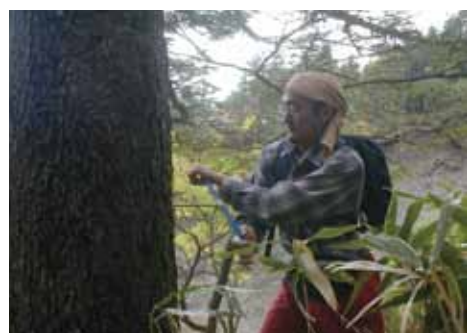
生長錐を使ってフィールドでサンプル採取をしているところ
