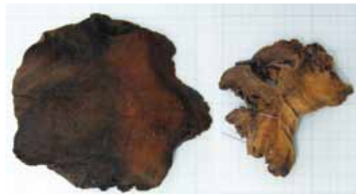
乾燥前 → 乾燥後 乾燥による出土木材の不可逆的な収縮
