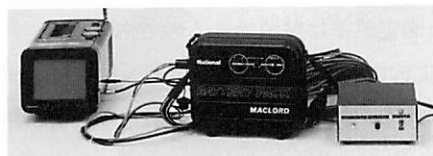
右より、コントロールボックス、 電池、モニター
