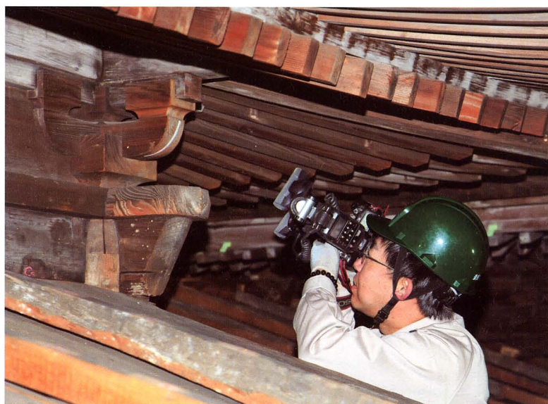
年代学研究室：国宝永保寺開山堂（岐阜県）の屋根葺替修理工事にもなう年輪年代調査
