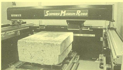
高松塚修理施設におけるデジタルアーカイブスキャナを用いた壁画のスキャン
