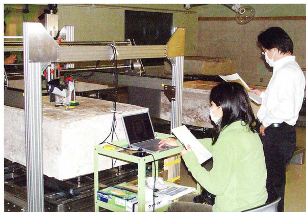
モバイル型蛍光X線分析装置を用いた壁画の調査。鉛の分布を調査したところ、画像部分では顕著に鉛のX線強度が大きくなる。双楹塚古墳（高句麗）の壁画とよく似た傾向を示している。
