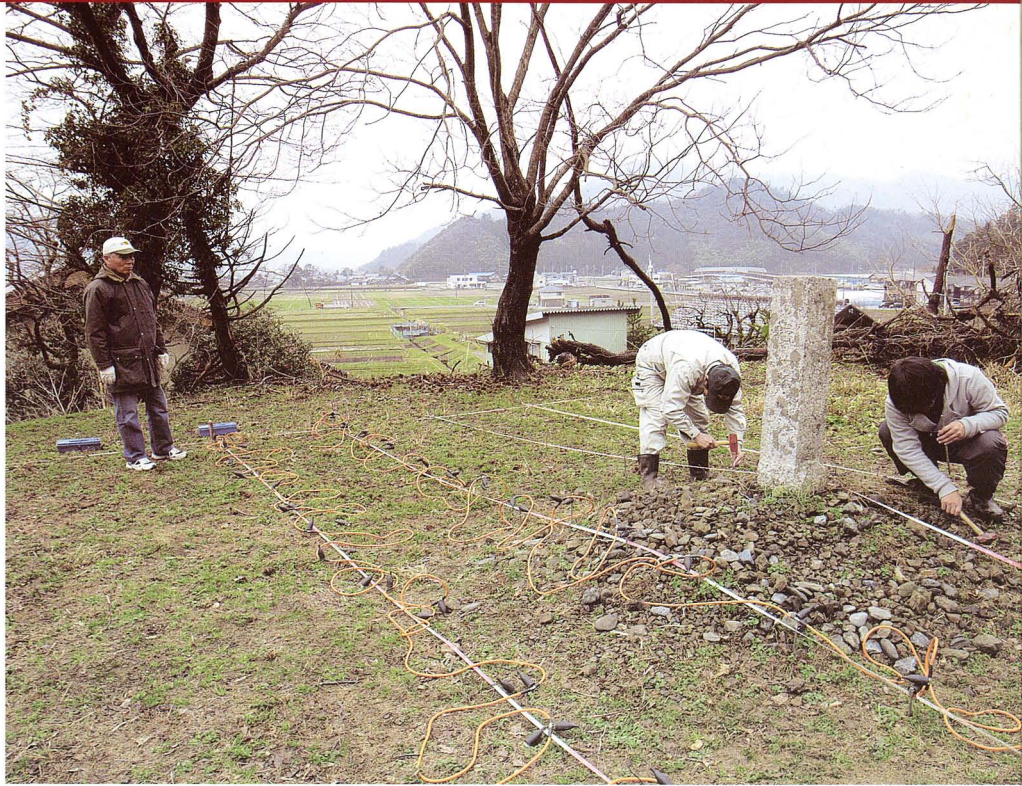
電気探査法による遺跡の探査
