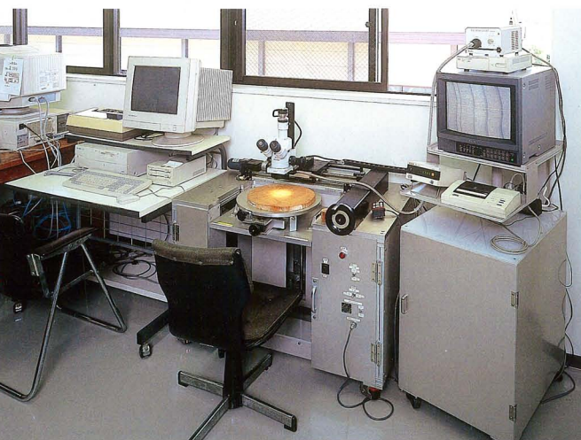
年輪読取器Ⅱ型 (特注品) モニタ出力とデジタル出力に対応した固定機
