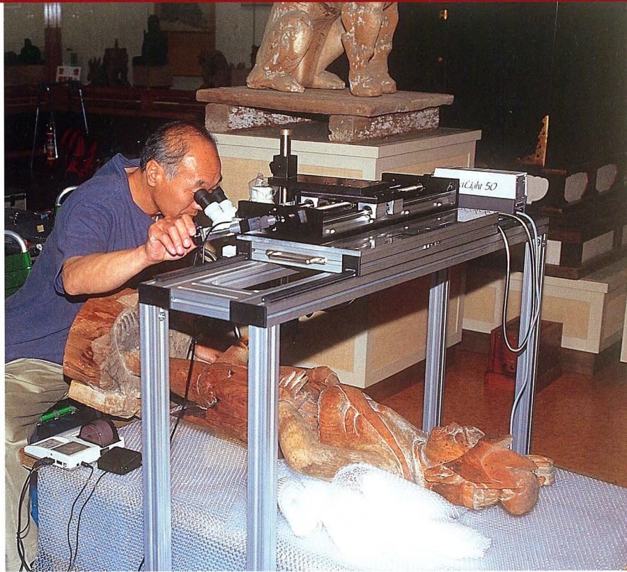
年輪読取器による作業風景(三佛寺にて) Operation of a tree ring measuring machine (at the Sanbutsuji Temple)
