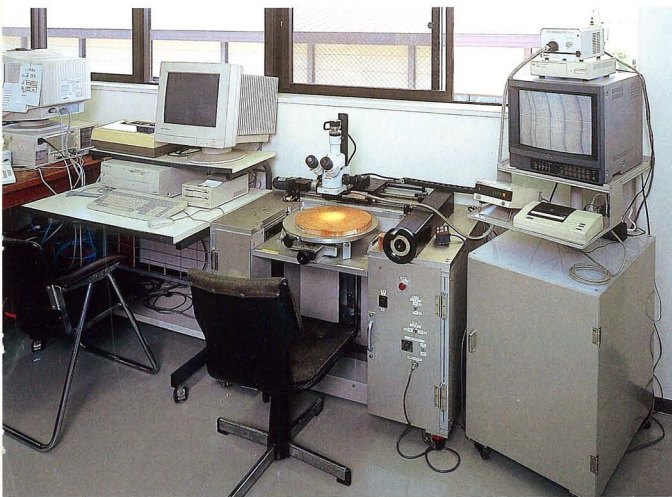
年輪読取器Ⅱ型(特注品) モニタ出力とデジタル出力に対応した固定機 Unit#2: Tree ring measuring machine (special order, Japan) A stationary device capable of monitor and digital output.
