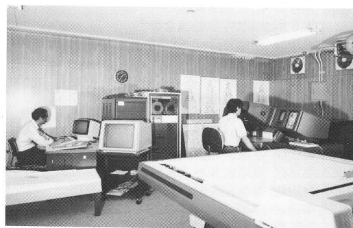
解析写真測量システム 解析図化機WILD AC-1を使用して、デジタル・マッピングなどを行う。
