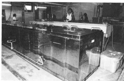
P.E.G含浸装置 ポリエチレングリコールを使用し、木材、木器等を永久保存するための処理装置
