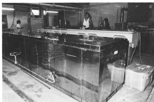
P.E.G含浸装置 ポリエチレングリコールを 使用し、木材、木器等を永 久保存するための処理装置
