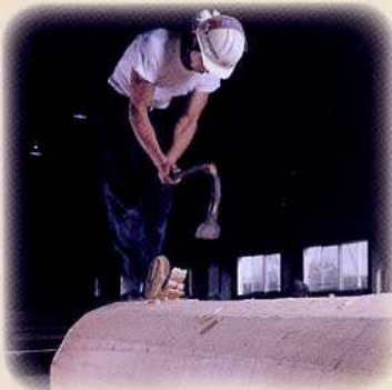
部材の加工・仕上げには古代の道具を用いました。写真のヤリガンナ仕上げに加え、柱はチョウナで加工しています。
