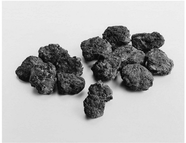
図198 椀形鉄滓 (手前：小型、左奥：中型、右奥：大型)
