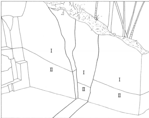
Fig. 50 墓道部東壁の地割れの痕跡 （太線に沿って地層が切断されている）
