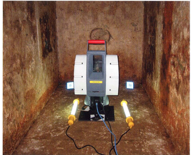
Fig.59 3次元レーザースキャナーの設置
