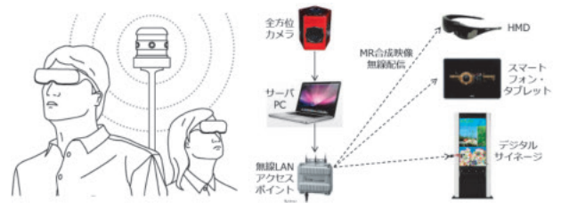
図5 クラウド型MRシステムの処理の流れ
