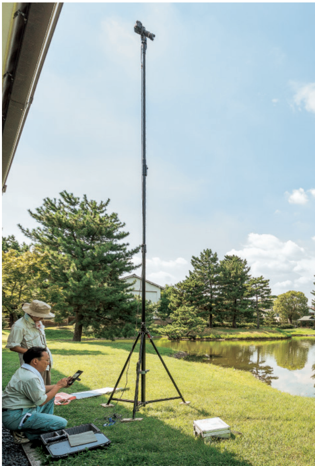
高所ポールを使用した高精細リモート撮影 High precision remote photography using an extension pole
