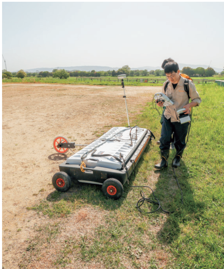
遺跡・調査技術研究室：アレイ式地中レーダー探査の試験（平城宮跡） Archaeology Research Methodology Section: Experimental survey using array GPR (Ground Penetrating Radar, at the Nara Palace Site)
