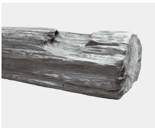
Fig. 189 SA4730出土柱根のえつり穴
