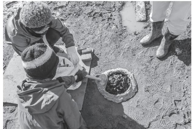
図63 復原火床炉での送風・燃焼実験
