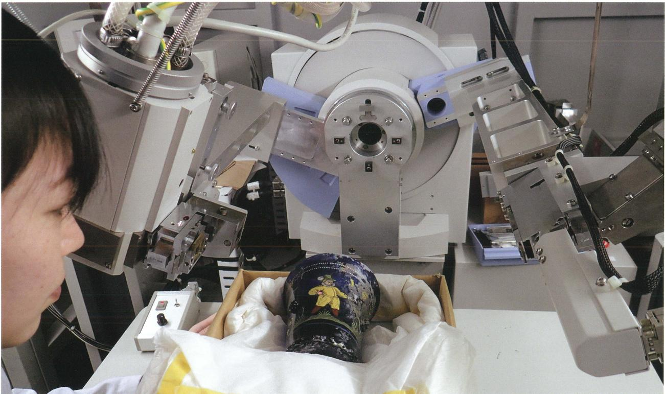
図7 X線回折分析 (Philips製 X'pert-MPD PW3050)
