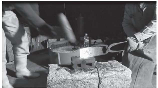
図19 鉄矢の鍛造加工
