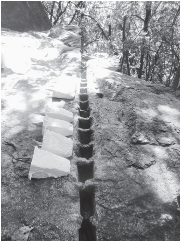
図18 型取りをした小豆島岩谷石切場の元和・寛永期の矢穴
