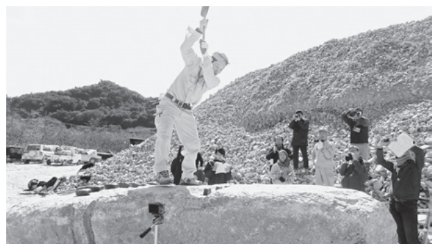
図22 玄能で鉄矢を叩く矢締め（石割工程）
