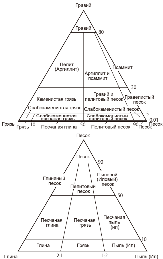
Схема 1. Классификация почвы по гранулометрическому составу (Цитата со стр.112 "Руководства по исследовательским раскопкам. Раскопки населенных пунктов")
