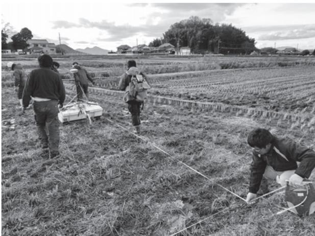
図175 地中レーダー探査風景
