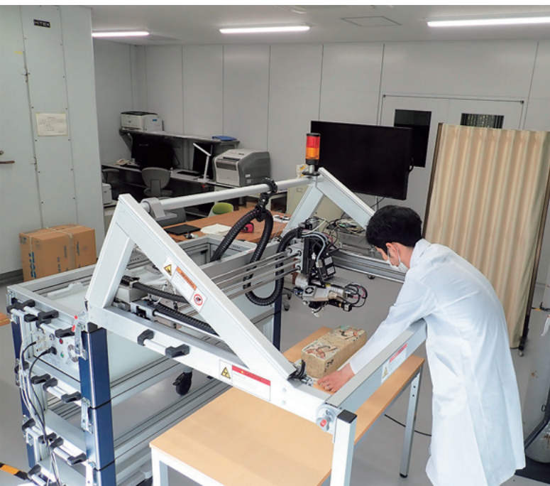
保存修復科学研究室：全資料型非破壊元素マッピング分析システムによる色料の調査 Conservation Science Section: Investigation of pigments using a non-destructive whole specimen elemental mapping system
