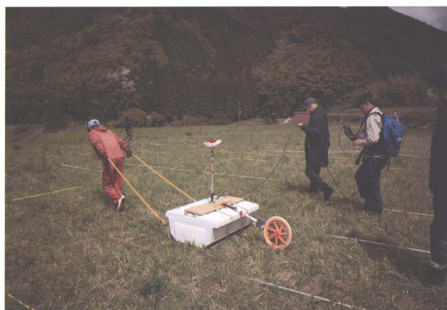
地中レーダー探査風景
