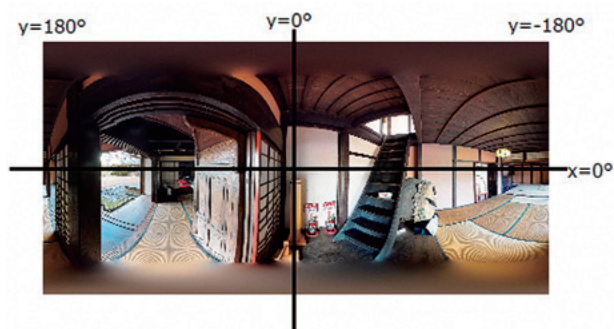
図3 y=0°で出力した正距円筒画像
